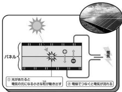
図1 太陽光発電の仕組み
