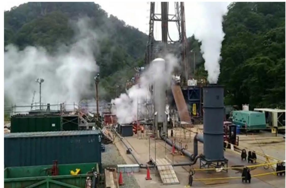
仮噴気試験の様子(鉛川地区)
